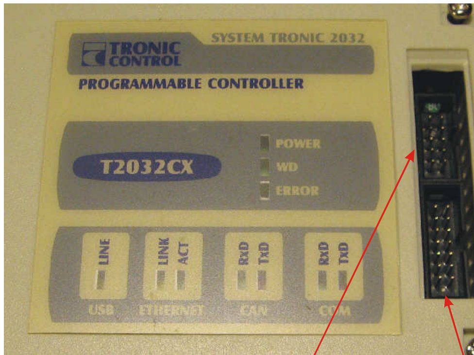
konektor technologické sběrnice TLB
